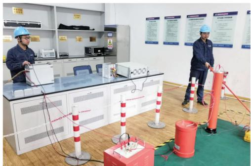
电力电缆交流耐压试验 彭万明 摄
